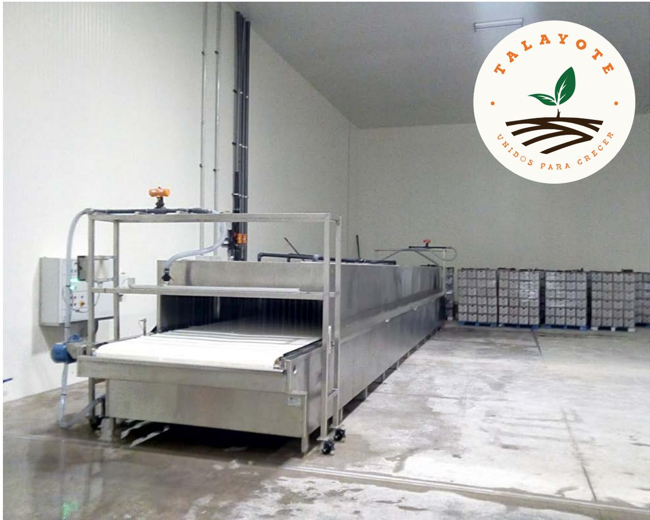
Instalación de sistema de fabricación e inyección DeepChill, suministro e instalación de sistema de enfriamiento hidrocooler, suministro e instalación de sistema de refrigeración para conservadores de frescos, suministro e instalación de panel para cuartos de conservación y área de empaque.
